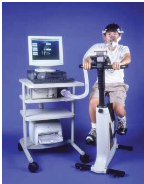
Εικόνα 1.4 Το σύστημα μέτρησης μεταβολισμού TrueOne χρησιμοποιεί ηλεκτρονικούς αισθητήρες ροής, αναλυτές αερίων και τεχνολογία υπολογιστών. Αυτές οι συσκευές χρησιμοποιούνται για τη μέτρηση της πρόσληψης οξυγόνου και της παραγωγής διοξειδίου του άνθρακα κατά την ηρεμία και κατά τη διάρκεια της άσκησης.
