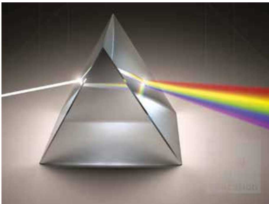
Εικόνα 1-2. Όταν μία δέσμη φωτός διέρχεται μέσα από ένα πρίσμα, οι διάφορες ηλεκτρομαγνητικές ακτινοβολίες του ορατού φωτός διαθλώνται και φαίνονται σε διακριτές έγχρωμες ταινίες που ονομάζονται φάσμα.
