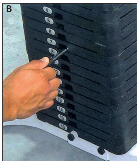
Εικόνα 9-6. Εξοπλισμός για ισοτονική εξάσκηση. (Α) Τα περισσότερα μηχανήματα εξάσκησης είναι ισοτονικά. (Β) Η αντίσταση μπορεί να μεταβληθεί πολύ εύκολα μετακινώντας τον πύρο στη στοιβία των πλακών. (Αναδημοσίευση κατόπιν αδείας από Cybex International.)
